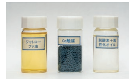
一番右の軽油は、植物油（左）に水素化脱酸素と異性化の化学反応を引き起こす触媒（中央）を与えたもの
