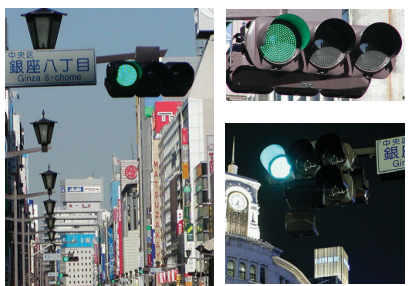
東京・銀座で初めて採用されたLED信号機。西日などの影響を受けずに遠くからもよく見えること、色の切り替えが早いことなどから、その安全性は高く評価されている。
