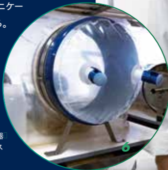
5 研究に用いる質量分析機器 6 特定の腸内細菌を持つマウスを飼育する無菌装置
